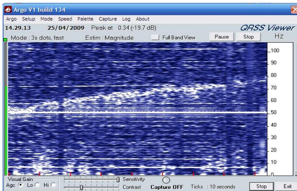
In questa schermata si può osservare l'emissione sconosciuta che sta spaziando sulle frequenze dai 50Hz ai 80Hz, sono visibili anche alcune tracce di apparati ricetrasmittenti.
